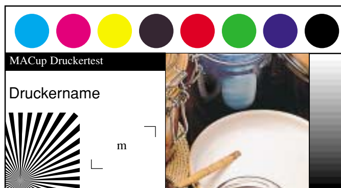
Der MACup-Proof im Original: Das „m“ wird in Times, 10 Punkt, erstellt und nach dem Druck auf 700 Prozent vergrößert.
